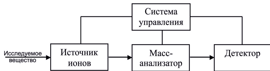
Рис. 3.1. Упрощенная схема масс-спектрометра
